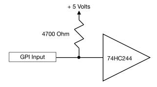
**Detail Of CMOS GPI Inputs**
